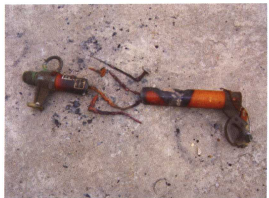
图 2-55 另克过热烧断残体可见光照片
