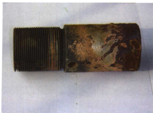
图 2-67 主变套管将军帽导电杆丝杆熔焊可见光照片
