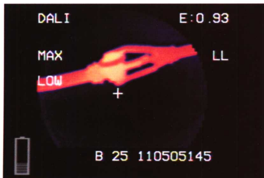
图 4-25 220kV 隔离开关拐臂接触不良发热红外热像
