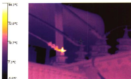
图 2-65 站用变低压侧套管螺丝发热红外热像
