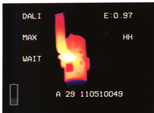
图 3-16 10kV 少油断路器上部螺丝松动红外热像
