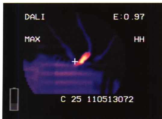
图 2-46 配网变压器套管线夹发热红外热像
