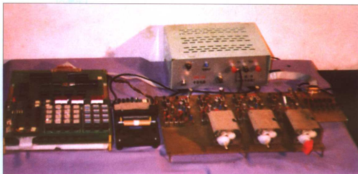
六盘水市广播电视局1995年5月对直属台电视播出停播进行监测的CMC-80单板机
