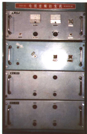
六盘水电视转播台1976年4月安装在梅花山上的简易中频调制器(第二机箱)DCH-10型电视差转机
