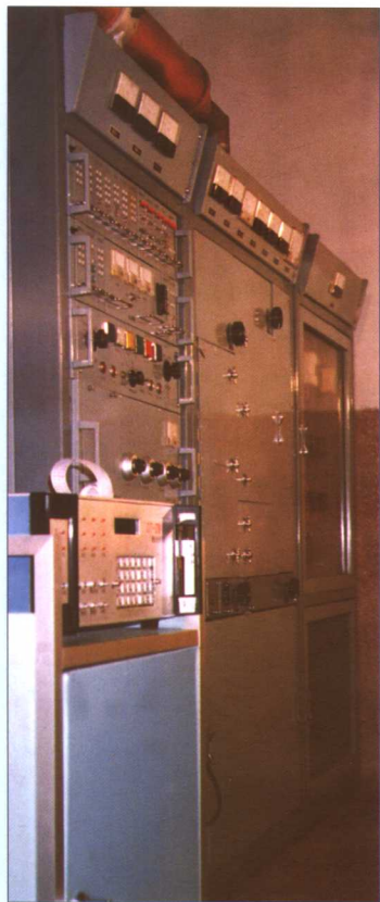
1987年10月，794台用来控制和检测10千瓦调频发射机的GT-I型微机
