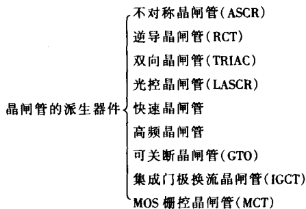
图 1.1.2 晶闸管的派生器件
