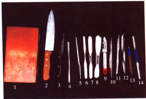
1.刀盒 2.切刀 3.主刀 4.刻线刀 5-8.U型刀 9.削皮刀 10-13.V型刀 14.平口槽刀
