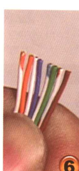
剪平双绞线后裸露部分长度约 14mm
