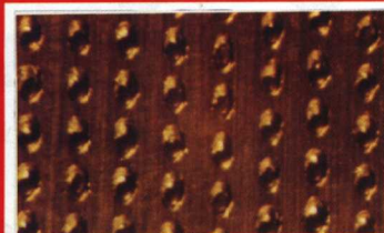
● 激光毛化轧辊表面显微图
