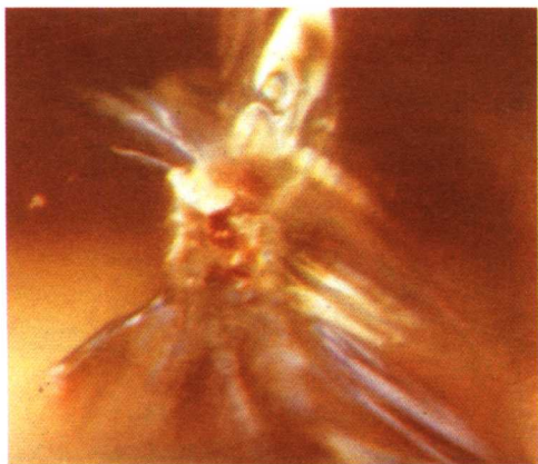
图 6-8 天然钻石中由晶体包裹体引起的象形(蝴蝶)包裹体
