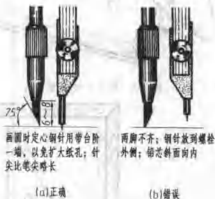
图 1-7 定心钢针和铅芯的安装
