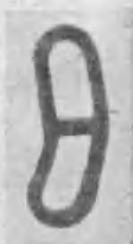
圖 3 刮板运输机內鏈側 鏈环的塑性变形
