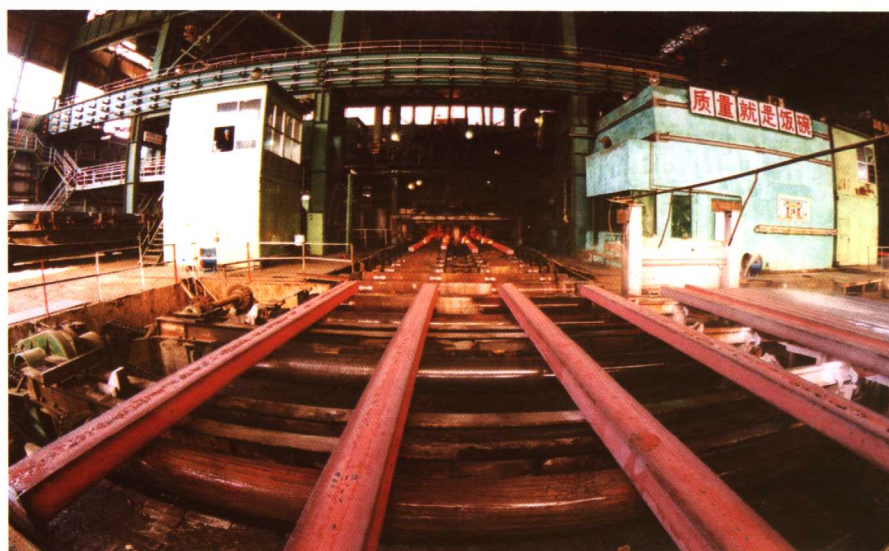
天铁冶金集团有限公司炼钢厂四机回流方坯连铸机正在生产
