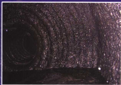
鞍钢弓长岭选矿厂 \phi 2.7\text{m} \times 3.6\text{m} 球磨机磁性衬板端衬保护层
