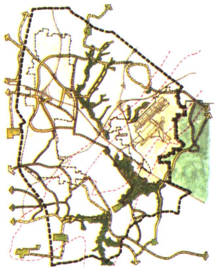
图版 15 绿色基础设施规划。设计过程开始于环境和生态因素的详细目录，以创建一个互相连接的绿色空间的框架，作为所有后续开发的基本框架。
