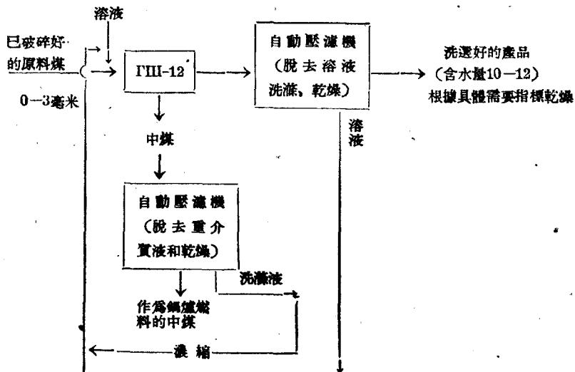
在分離離心機 “ГІІІ-12” 上得到的帶有精煤的溶液送往第二個洗選裝置上去，即離心機 “ГІІІ-12”。在這台離心機上輕質段分（精煤）就從工藝溶液中分離出來。這項操作有雙重意義。一方面，可以得到預先（在洗滌前）已乾燥了的精煤；此外，在離心機 “ГІІІ-12”\*（在離心場裡輸送精煤）裡進行着精煤的補充再精選，將其中分散最細的礦物雜質除去。必須指出，這台離心機與第一台分離離心機 “ГІІІ-12” 配合起來就是目前的機器組合，這個組合可以使我們實現煤體的最高效率的物理脫灰。
