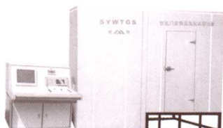
MWJ系列智能门窗保温性能试验机
