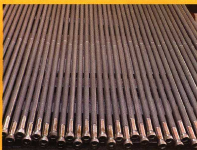
过滤管清洗后
