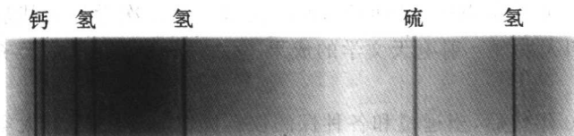
图 1-2 光谱图中三种元素的吸收线
