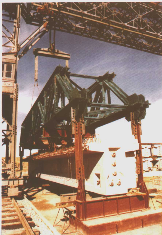
现场桥梁静载试验
