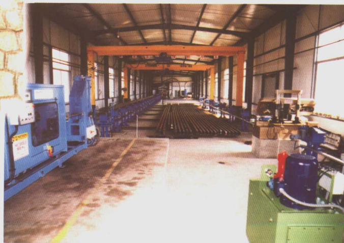
长轨条焊轨基地焊轨流水线
