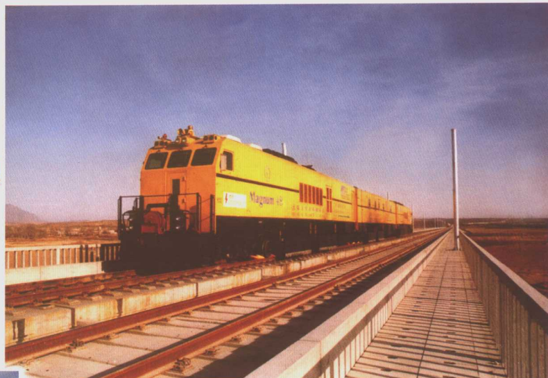
钢轨打磨车正在打磨钢轨
