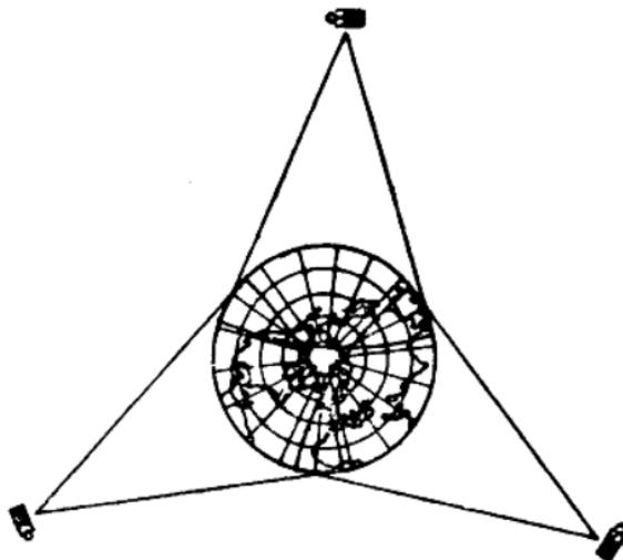
准地球，在地球表面三分之一的区域内，都能接收到卫星发射出来的无线电波。如果在这个区域内，架设起一个又一个卫星地面站，那么，在任何两个站之间，就可以通过卫星，进行无线电通信了。要是将轨道上的通信卫星增加到三颗，而且每颗之间都相隔 120 度左右，那么在地球上的任何地方，都可以通过这三颗卫星进行通信，全球卫星通信即可以实现了。这在当时是多么大胆的设想啊！
