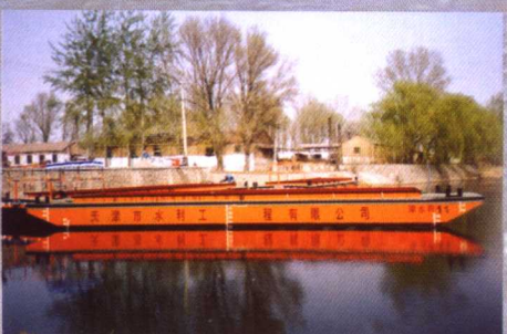
天津市海河清淤工程用运泥驳船
