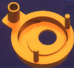
使用表面补片的方法, 对按钮零件表面进行补片操作
