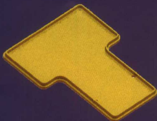
以底盖零件为例, 练习使用扩展分型面创建分型面的方法
