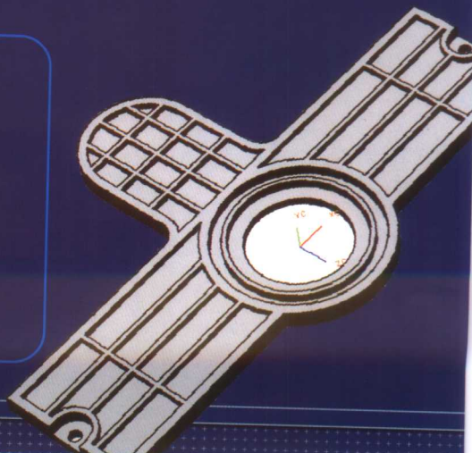
使用表面补片的方法, 对按钮零件表面进行补片操作
