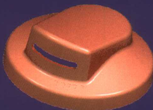
以盒盖零件为例, 介绍使用分割实体的方法创建修补块
