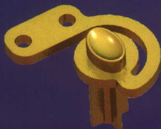
以盒盖零件为例, 介绍使用分割实体的方法创建修补块
