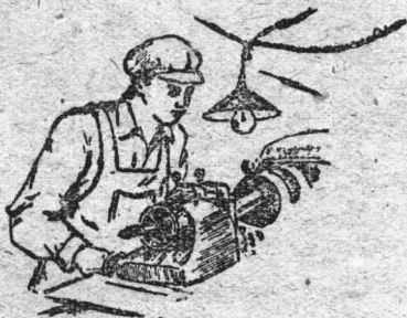
图 8 机床局部照明应采用安全电压
