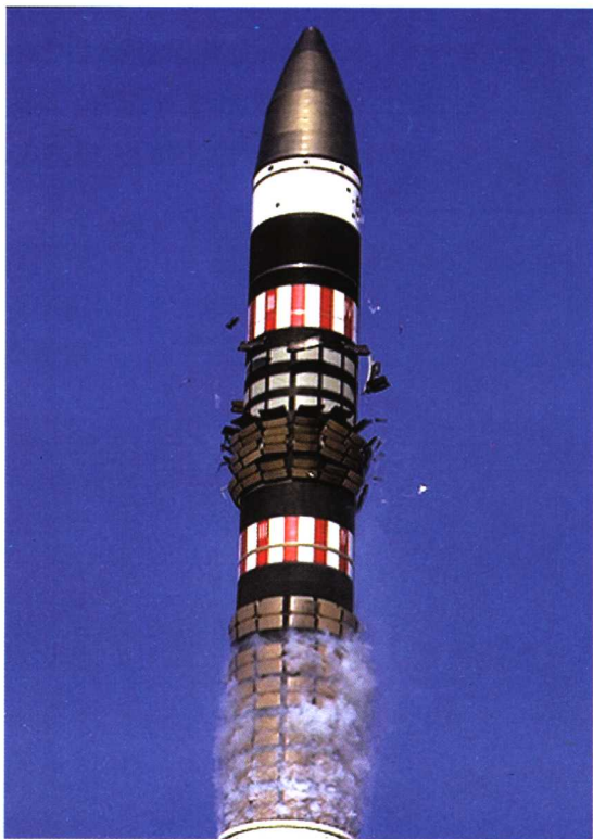
正在发射的“和平卫士”导弹上的隔热瓦正从弹体上脱落
