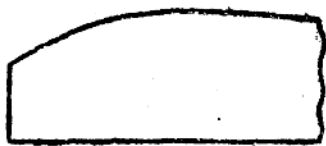
图3 成型铣后的微观曲线形状。
