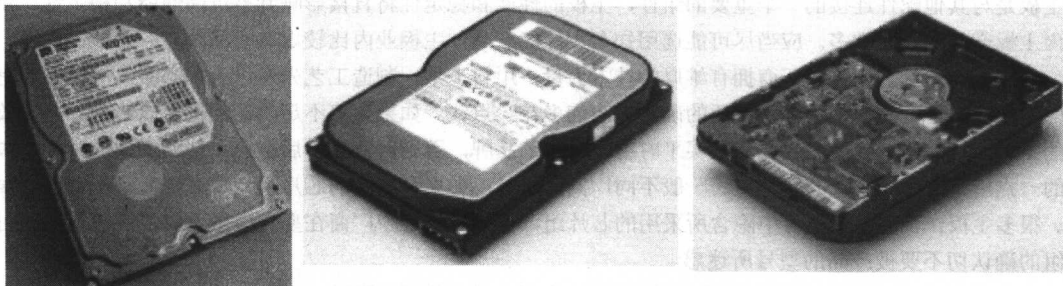
图 1-4 台式 PC 机用的 3.5 英寸硬盘
