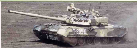
▲ 这是 T-80UK 型指挥坦克。照片中的车体装有“窗帘-1”防护系统的雷达探测装置、烟雾弹发射器、爆炸反应式装置等。
