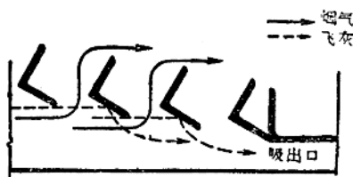
图8 叶片间隙中烟气和飞灰流动路线示意图
