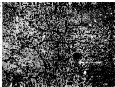
图11 含有1.14%镍的焊缝金属
