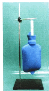
图 1-4-1 两段铅柱间的分子引力足以吊起 1 kg 重物
