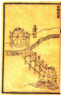
高转筒车图 唐代农业生产发展的一个重要方面是水车普遍用于农田灌溉。
