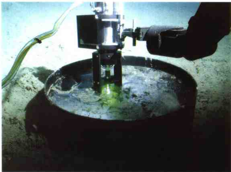
图 1-6 \text{CO}_2 注入海底试验的海底观测站
