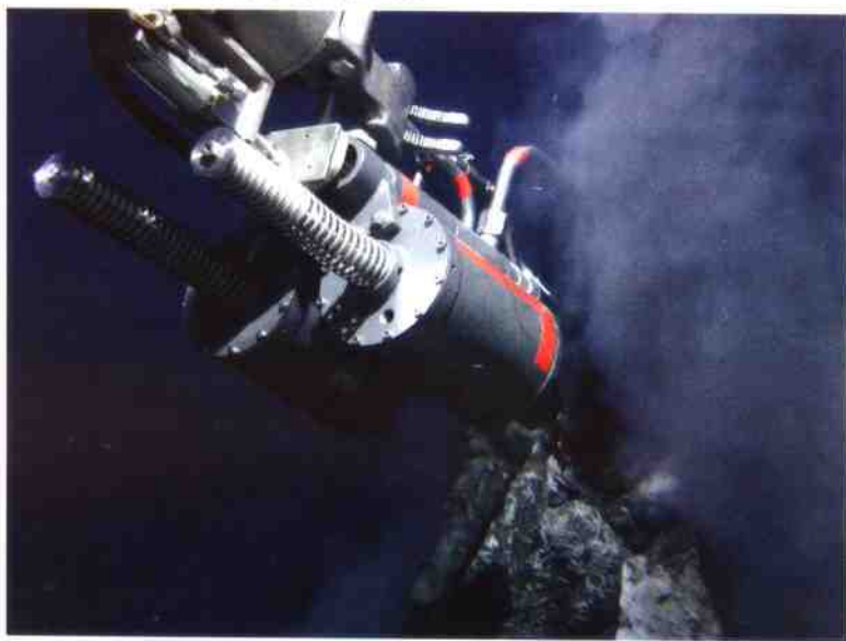
图 1-2 Major Pairs 采样器在东太平洋隆起地区热液口进行采样作业(2002 年 1 月)
