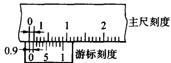
图 1-2 0.1 mm 游标卡尺的刻线原理
