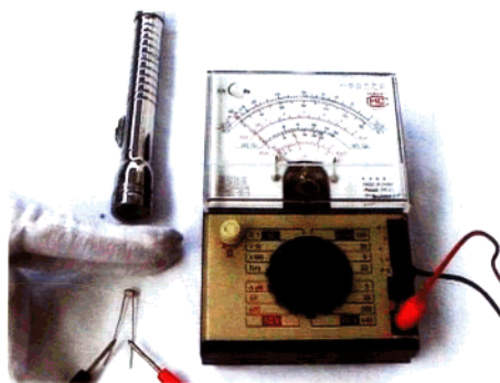
(b)遮光时光敏电阻器的阻值测量
