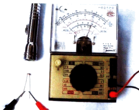
(a)光照时光敏电阻器的阻值测量
