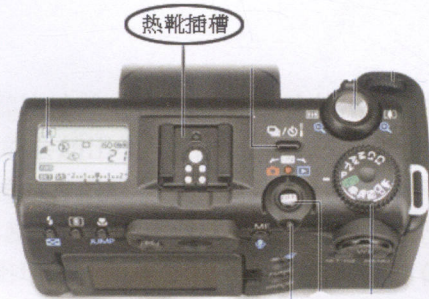
∴ 可安装外部照明设备的热靴插槽
