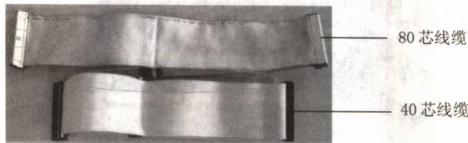
ATA 100 是硬盘生产商昆腾(Quantum)联合几大厂商在原有的 ATA 66 基础上推出的新一代接口类型，这个接口得到了英特尔和其它一些主要芯片制造商的支持，目前的主流主板芯片组都支持该标准。ATA 100 硬盘的最大特点就是将硬盘的最大外部数据传输率提高到了 100MB/s，在数据线方面，它与 ATA 66 一样，使用的是向下兼容的 80 芯数据线。
