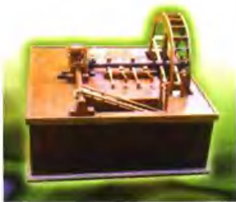
明代的“水轮三事”复原模型，用一个水轮同时驱动水碓(用于谷物脱粒)、水磨及水车
