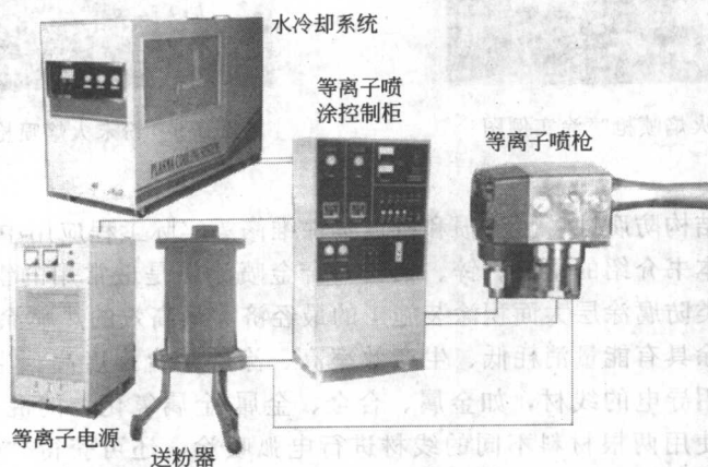
图 1-12 典型的等离子喷涂系统组成示意图
