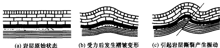
图 1.2 构造变动与地震形成示意图
