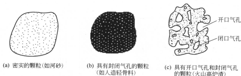
图 1-2 颗粒的气孔与空隙的类型
