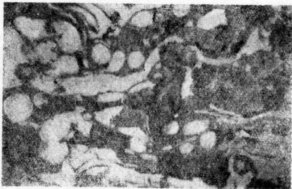
圖 1 切屑凝固体放大130倍的顯微磨片。
