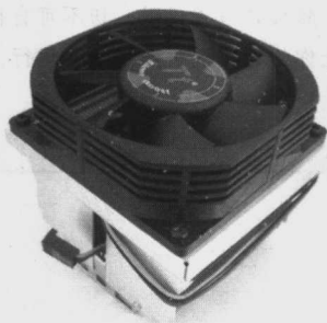
常见的散热器对中央热量最高的CPU来说,会出现一个锥形盲区,影响散热效果
