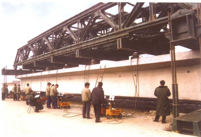
24 m 单线整孔箱梁静载试验
