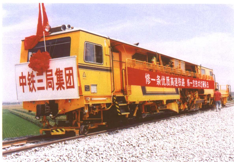
09-32 连续式自动抄平、 起拨道捣固车
