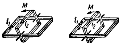
圖 13-26. 瓦特計兩綫圈电流相对相位的变化。
