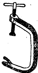
圖28 弓架形彈簧拆裝器
