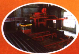
钢管抛丸除锈生产线
