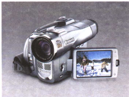
■ 具有20倍光学变焦的佳能MVX350i，采用了全新ND滤镜系统，静态拍摄效果极佳
