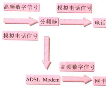
通过ADSL上同是在电话线两端分别安置ADSL设备，通过同一电话线上网、打电话和收发传真，且互不影响。其工作原理如图所示。
