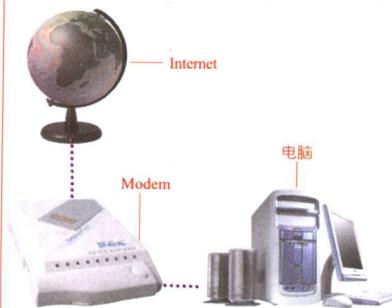
通过传统的Modem拨号上网是以前相当普及的一种上网方式，一般简称拨号上网。由于拨号上网的网速较慢，目前已逐渐被淘汰，其连接方式如图所示。
