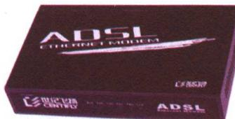
传统的 Modem 拨号上网和 ADSL 宽带上网都需要调制解调器，只不过 ADSL 宽带上网使用的是 ADSL Modem（如图所示）。
