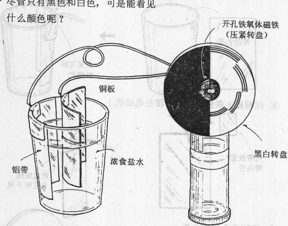
★ 电动机旋转的速度，随着铜板的往上提和往下放，以及同铝板靠近和离开而改变。
