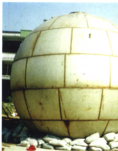
球形压力容器无模爆炸成形
