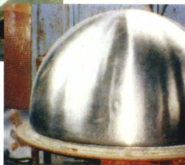
复杂曲面零件 爆炸拉深成型
