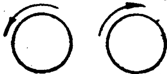
图 1 — 9 用微倾螺旋调整长水准气泡居中
