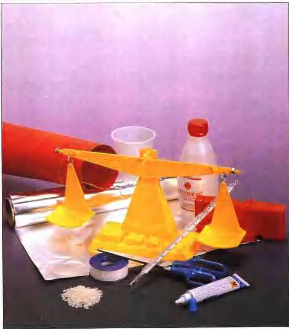
1 先将2个螺帽拴在天平横梁两端，然后将2个金属环装入孔中。
