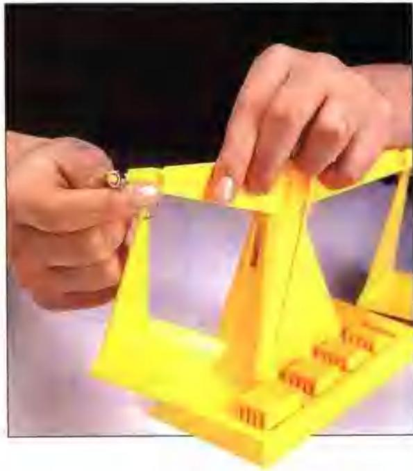
现在，你有一架安装好而且保持平衡的天平了。虽然它不是一个十分精密的仪器，但别忘了，测量仪器的精确度还得靠操作者的技术。
