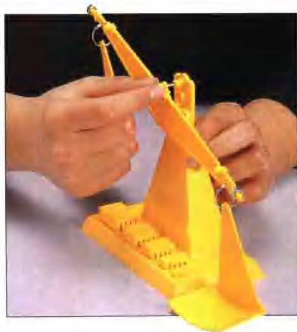
3 安装基座，并将金属轴穿过天平横梁中央凸出的孔，再插入基座顶端的孔中，最后套上塑胶轴帽。
