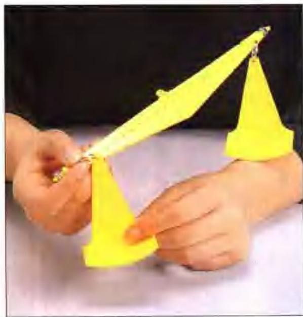
2 每个环上吊一个秤盘，两个秤盘与中心点的距离应相等，秤盘放置物体的那一面，要与横梁有刻度的一面方向相同。
